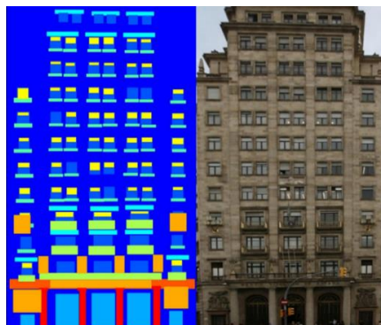
24 pav. Semantinis pastato fasado segmentavimas. Apmokytas algoritmas atpažįsta objektus ir juos suskirsto pagal apmokytas klases bei sužymi plotus kaukėmis (angl. masks ). Paimta iš „Center for Machine Perception“ (liet. mašininio įvertinimo centras) fasadų semantinio segmentavimo ištekliaus [interaktyvus]. Prieiga per internetą: < http://cmp.felk.cvut.cz/~tylecr1/facade/ > [žr. 2018-12-10].
