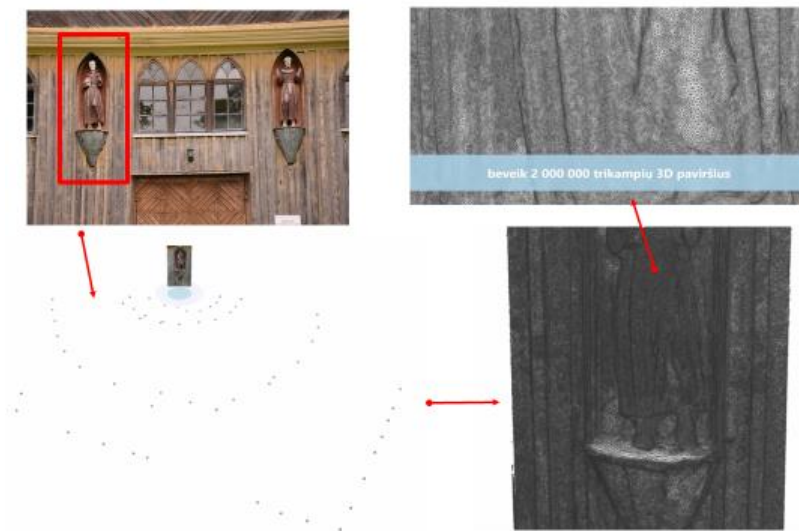
7 pav. Fotogrametrijos metodu fiksuotos medinės fasado skulptūros 3D modelio kūrimas. Skaitmeniniu fotoaparatu skulptūra fiksuota trim atstumais, išlaikant tą patį židinio nuotolį. Trimačiui modeliui kurti panaudotos 35 nuotraukos iš įvairių rakursų. Paimta iš VŠĮ „Paveldo komunikacija“ archyvų.
